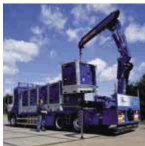
Удобство транспортировки и хранения. Два компактных насоса могут быть размещены на грузовике поперек кузова или даже один над другим
